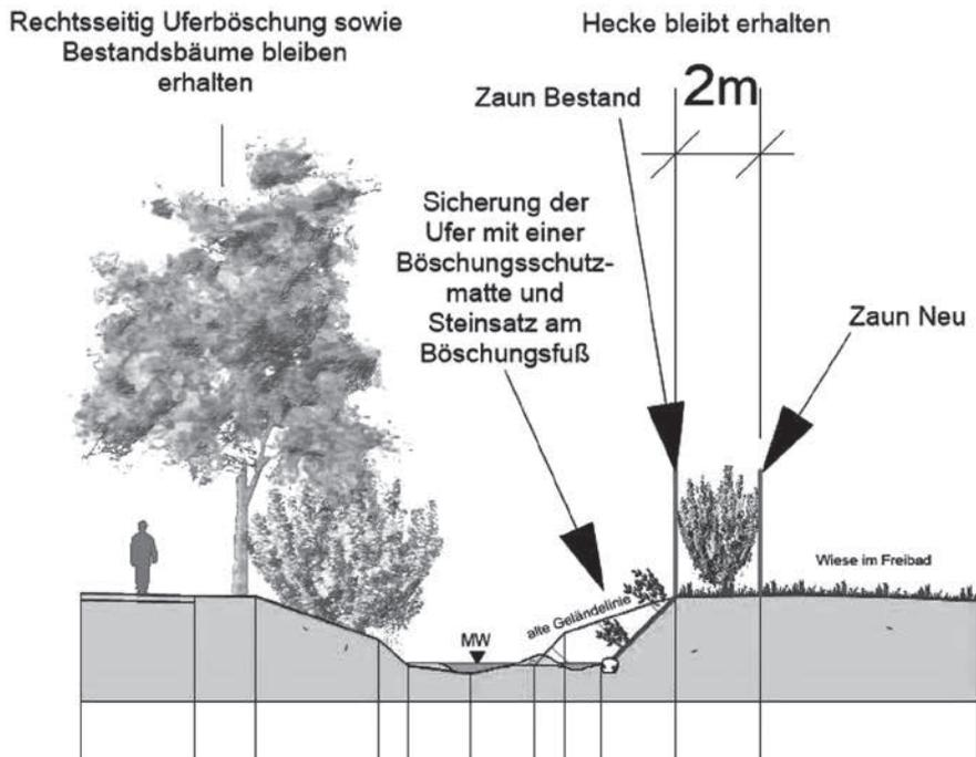
Dafür sind aber die Ausführung einer Böschungsschutzmatte und Steinsatz am Böschungsfuß erforderlich, weil der Zaun näher an der Böschung stehen würde. Dadurch würden Mehrkosten von ca. 5000 € entstehen, aber dafür würden nur wenige Zentimeter Freibadfläche verloren gehen.
