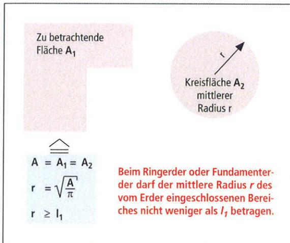
Bild 5.5.1.2 Erder Typ B – Ermittlung des mittleren Radius – Bei-
